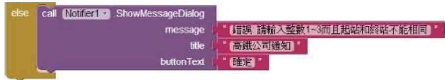
Step9：將 Step3~Step8 的所有拼圖塊，都置於「when Button1.Click do」拼圖塊之中，完成此 App 的設計。
