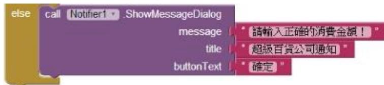
Step9：將 Step3~Step8 的所有拼圖塊，都置於「when Button1.Click do」拼圖塊之中，完成此 App 的設計。
